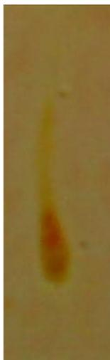
**Figura 2.** Placa de cromatografia com reagente de Dragendorff revelador de alcaloides.
