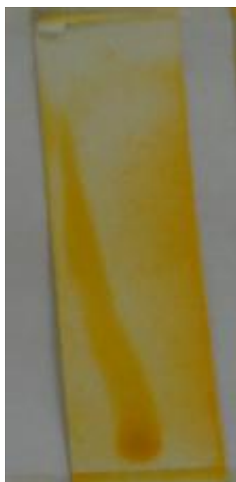
Figura 2. Placa de cromatografia em camada delgada (CCD) com reagente de Dragendorff (cor laranja)
