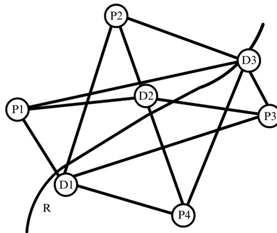
**Figura 6.1:** Pedreiras fornecedoras de pedra britada:  $P1$ ,  $P2$ ,  $P3$  e  $P4$ ; pontos convenientes para depósito de material:  $D1$ ,  $D2$  e  $D3$ ; trajeto da rodovia  $R$ .
