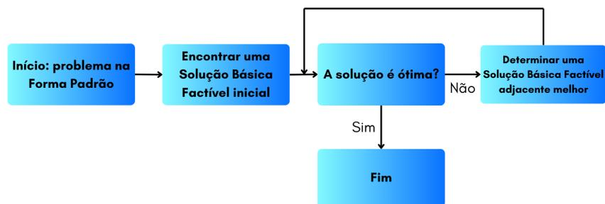
Figura 4.1: Fluxograma da descrição geral do algoritmo Simplex.
