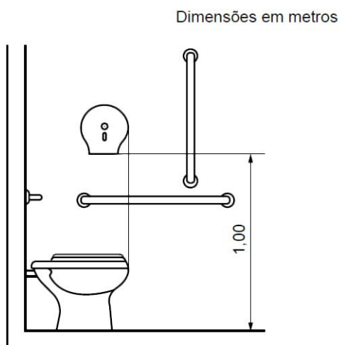
Figura 124 – Localização da papeladeira de sobrepôr (rolo) – Vista lateral
