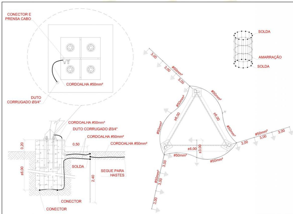
3.4.2. Composto por um mínimo de 03 (três) radiais, com 10 m (dez metros) de comprimento cada uma, aproximadamente.
