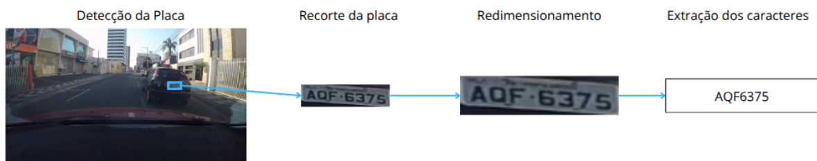
Figura 23 - Pipeline de Reconhecimento de Placas de Veículos.
