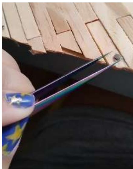
Figura 25 - Processo de colocação dos ímãs realizados com auxílio de pinça de precisão.
