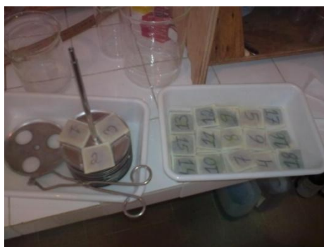
Figura 16A – Determinação de fibra por meio da metodologia Nylon Bag, UESB, Vitória da Conquista - BA. Fonte: SANTOS, A.O., 13/08/2010.
