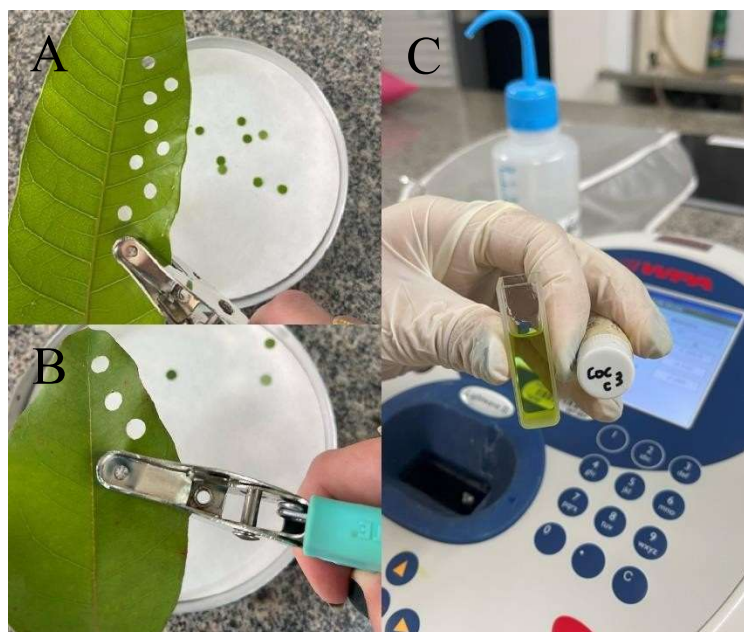
Figura 6 - Corte de discos foliares de folha de mangueira (A) e corte de discos foliares de folha de eucalipto (B) para determinação dos teores de pigmentos e processo de análise da absorvância de pigmentos fotossintéticos de amostra do tratamento ‘coquinho controle’(C).
