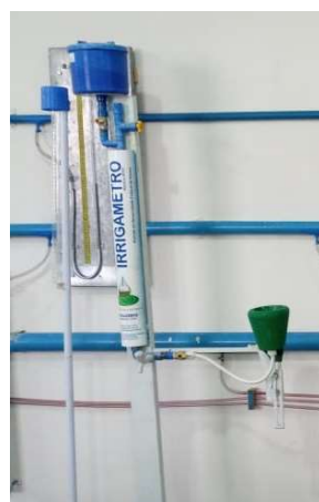
Figura 43 - Irrigâmetro usado para medir a evapotranspiração da cultura.
