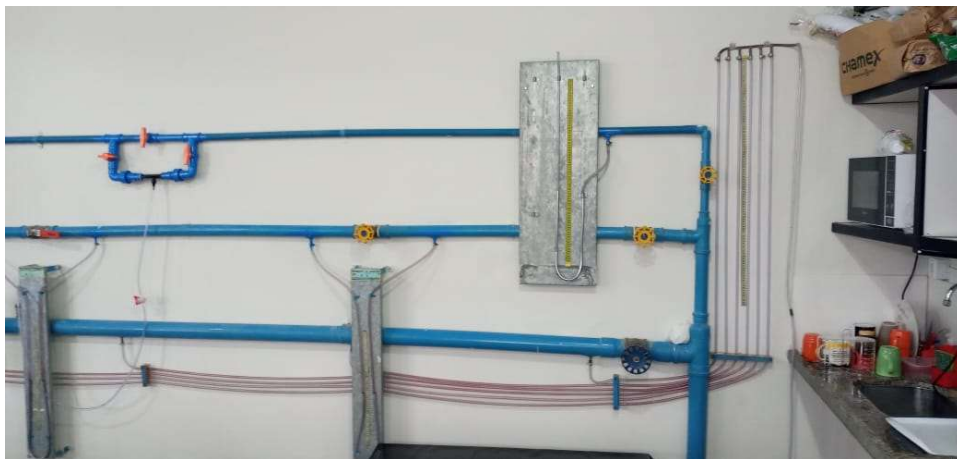
Figura 40 - Circuito com piezômetro simples; manômetro de mercúrio em U e diferencial.
