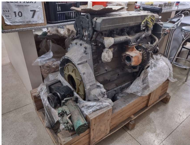
Figura 16 - Motor de combustão interna de máquina florestal (Forwader) utilizado em aula prática.
