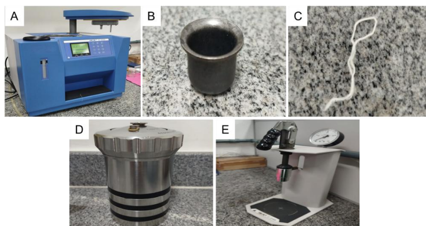
Figura 2. Bomba Calorimétrica modelo Ika C200 (A); cadinho recipiente (B); fio de ignição (C); reator de combustão (D) e equipamento de abastecimento de oxigênio (E).
