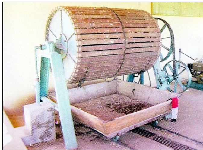
Figura 5. Lavador-descascador de tambor. Belo Campo - BA, 2002.
