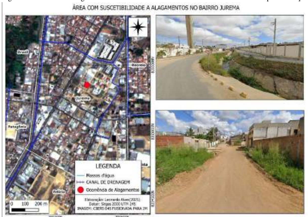
Figura 24 - Canal de Drenagem entre condomínios no bairro Jurema e ruas no entorno sem pavimentação
