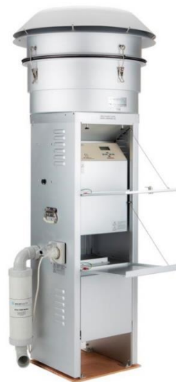
Figura 3. Amostrador de alto volume HiVol 3000.
