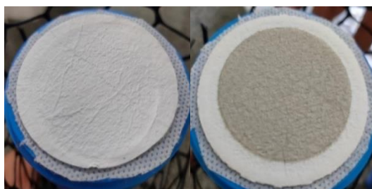
Figura 10. Partículas Totais em Suspensão coletadas no filtro de fibra de vidro.
