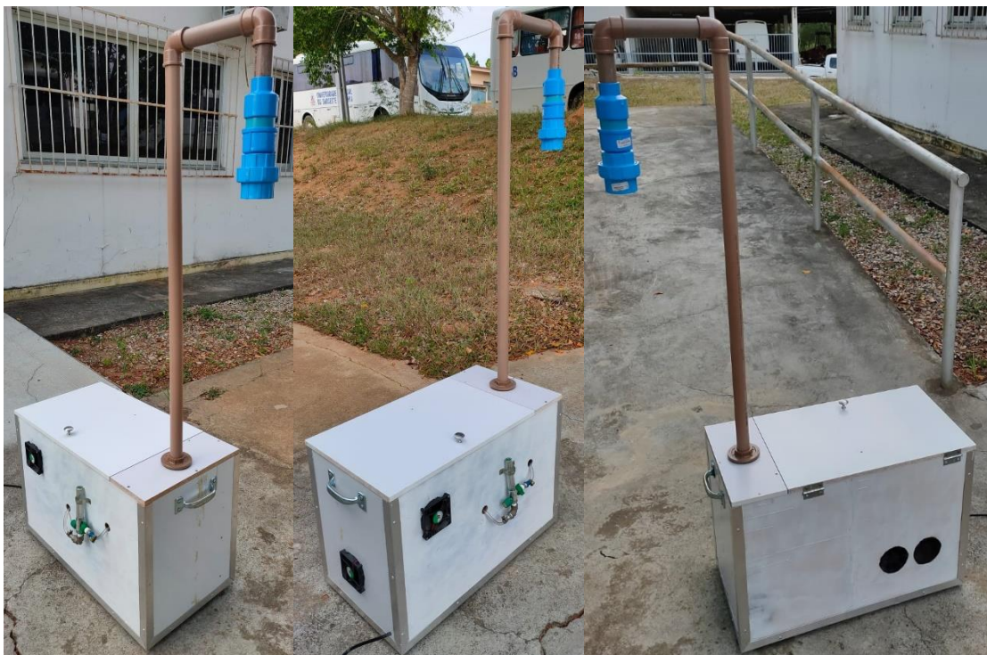
Figura 7. Amostrador de Partículas Totais em Suspensão desenvolvido neste trabalho.
