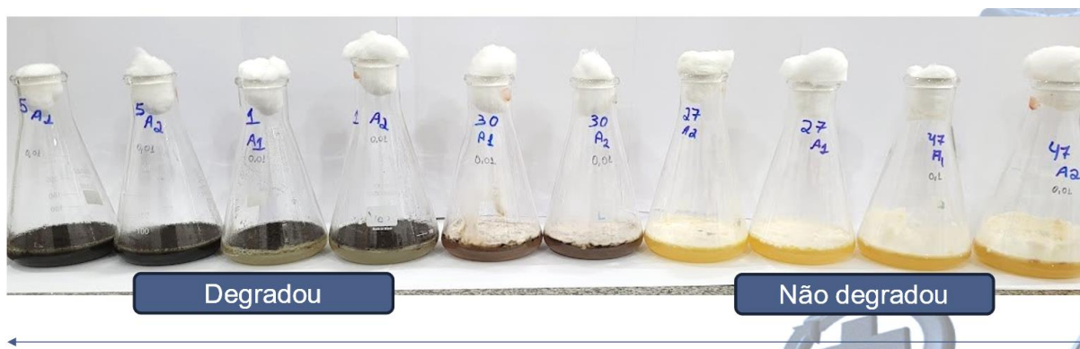
Figura 11: Comparação dos microrganismos selecionados, após 7 dias contendo 10 \text{mg.L}^{-1} de Amarelo tartrazina. Fonte: Autor (2024)
