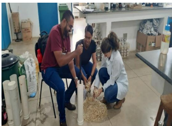
Figura 8. Enchimento e compactação do silo
