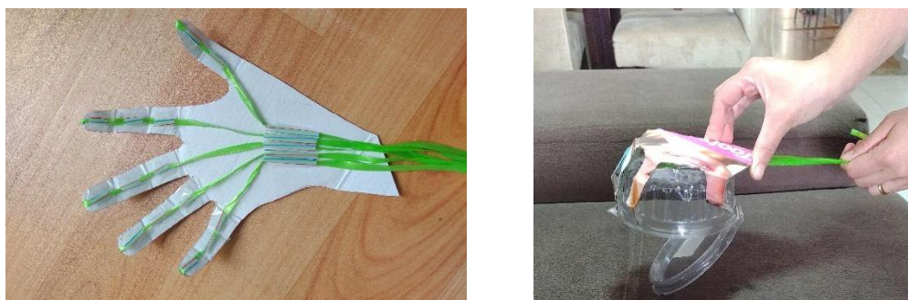
Imagem 16. Montagem final e funcionamento da mão mecânica
